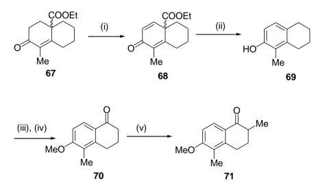
Reagents: (i) DDQ, dioxane; (ii)  $C_4H_9OK/C_4H_9OH$ ; (iii)  $Me_2SO_4$ ,  $Me_2CO$ ; (iv)  $CrO_3$ , MeCOOH; (v)  $Et_3B$ , NaH, Mel
