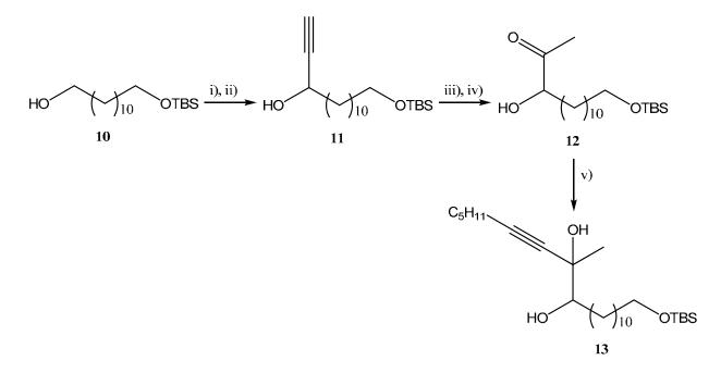
**Scheme 4.** *Reagents:* i) PCC, Celite, CH<sub>2</sub>CI<sub>2</sub>, 20 °C, 2 h (87%); ii) HCCMgBr, THF, (93%); iii) Ac<sub>2</sub>O, DMAP (cat.), pyridine, 20 °C, 16 h, (88%); iv) NaAuCI<sub>4</sub>.2H<sub>2</sub>O (cat.), aq. MeOH, reflux 5 h, then cool, add sat. aq. K<sub>2</sub>CO<sub>3</sub>, 20 °C, 1 h (79%); v) 2.2 C<sub>5</sub>H<sub>11</sub>CCLi, THF, -78 °C ~ 0 °C (95%).
